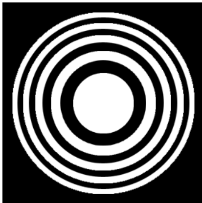
Fig. 8.20 – Placa com zonas de Fresnel.
